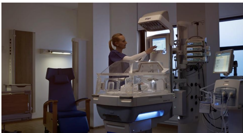
Dräger : une unité de soins intensifs néonataux équipée d'un incuwarmer Babyleo® TN500 et d'un respirateur de soins intensifs néonataux, famille Evita
